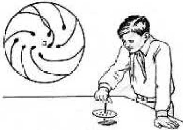
Fig. 42. Así corren las gotas de tinta por el cartón giratorio.
