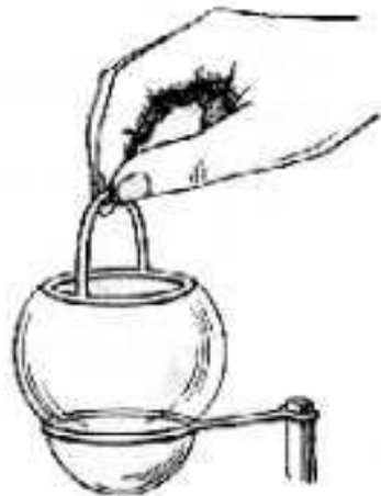
Fig. 67. Manera de obtener un cilindro con la película jabonosa.
