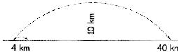
Fig. 28. El vuelo de una bala en el vacío y en el aire. El arco mayor representa la trayectoria que seguiría la bala si no existiera la atmósfera. El arco menor, la trayectoria real de la bala en el aire
